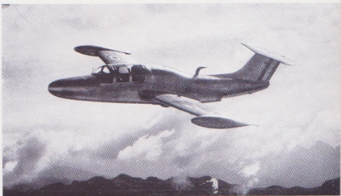
Morane Saulnier 760 PARIS. Avion de liaison et d'entraînement au vol sans visibilité.
